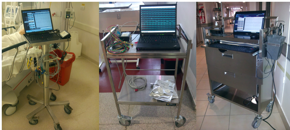
Figura 3. Prototipos de plataformas móviles para el sistema de ECG digital. Izquierda: pedestal para la Central de Emergencias. Centro: mesita en la Unidad Coronaria. Derecha: cajonera rodante en Internación General.
